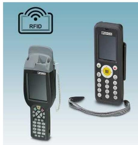
Мощные портативные устройства RFMARK UHF и RFMARK HF обеспечивают возможность бесконтактной идентификации, обмена данными и локализации маркировочных табличек при помощи встроенной технологии RFID без визуального контакта. При этом портативные RFID-устройства выполняют функцию передатчика и приемника.
