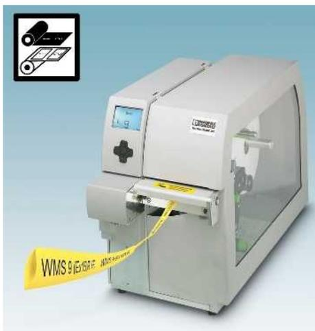
THERMOMARK W2 наносит обозначения и перфорацию на нарезаемые термоусадочные кембрики WMS. Двусторонняя маркировка гарантирует оптимальную читаемость обозначений на проводах и проводных линиях. Особая конструкция направляющей обеспечивает простоту вкладки кембрика.
